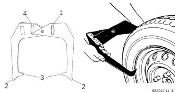
**Рис. 7. Определение данных колеса при помощи кронциркуля:**
