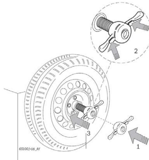
5. Ослабьте деблокирование и поворачивайте быстрозажимную гайку по часовой стрелке до тех пор, пока колесо не будет прочно зажато.
