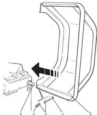
**Рис. 2. Установка защитного кожуха для колес в станке для балансировки колес WBE 4210:**
