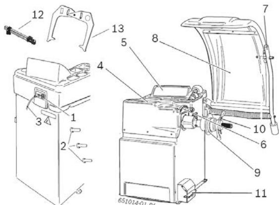
Рис. 1. Станок для балансировки колес (позиции расшифровываются в нижеследующей таблице).
