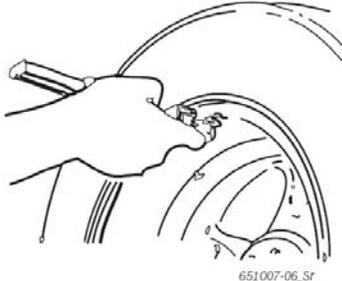
2. Приведите щипцы для наружных грузиков (поз. 5) в соответствующее положение, в котором должны закрепляться балансировочные грузики.
