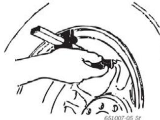
5. Установите второй требуемый приклеивающийся балансировочный грузик в щипцы для внутренних грузиков (рис. 6, поз. 3).
