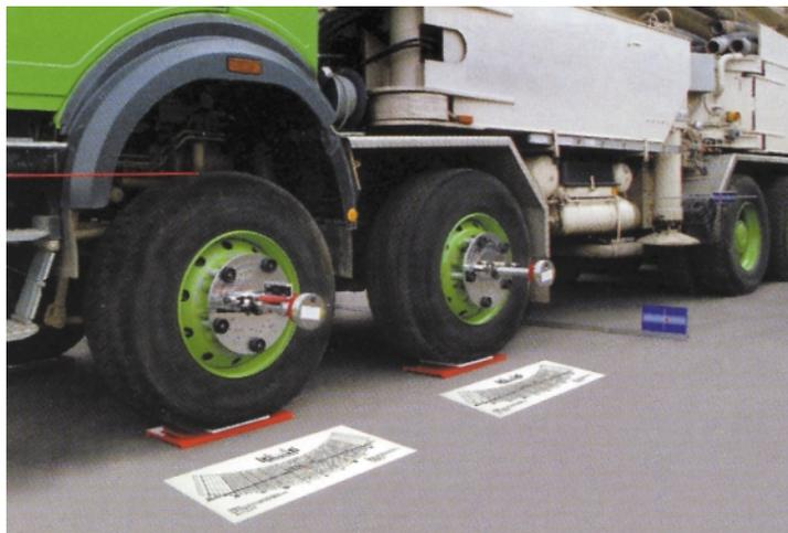
Лазерный стенд, который можно «приладить» к любому грузовому автомобилю на любой ровной площадке
