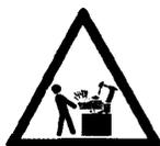
**ОПАСНОСТЬ РАЗРЫВА ШИНЫ ПО ПРИЧИНЕ ПРЕВЫШЕНИЯ ДАВЛЕНИЯ !**
