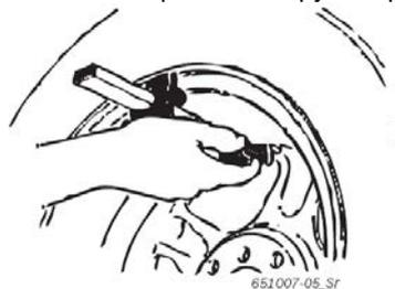
5. Установите второй требуемый приклеивающийся балансировочный грузик в щипцы для внутренних грузиков (рис. 8, поз. 3).
