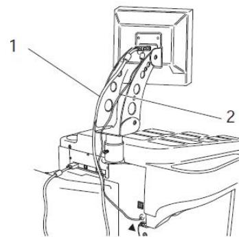
**Рис. 2. Соединение монитора и клавиатуры со станком для балансировки колес WBE 4515:**
