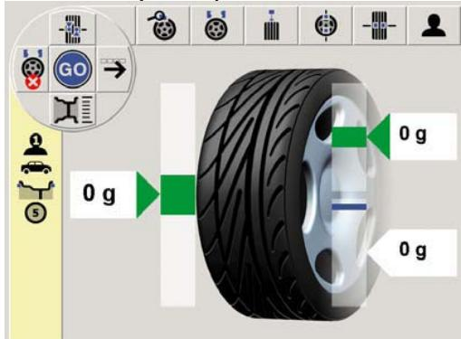
2. При отображении на дисплее «Auswuchtseite» («Страницы балансировки») нажмите клавиши «→» «→» «→» и **OK**.
