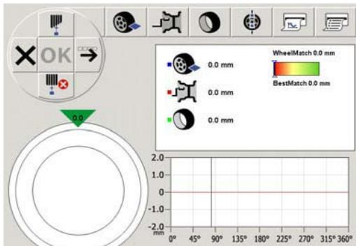
После завершения измерения все результаты измерений отображаются на мониторе численно и графически. Если колесо, обод или шина выбирается на панели меню, то отображается только соответствующий результат измерений.
