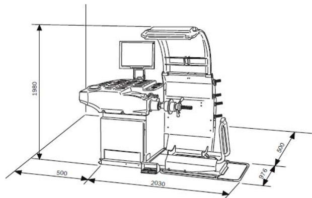
**!** Для надежного и эргономичного использования станка для балансировки колес WBE 4515 целесообразно устанавливать его на расстоянии примерно 0,5 м от ближайшей стены.
