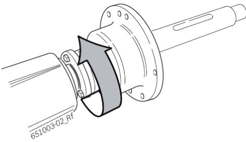
⇒ Оба винта находятся слева в отверстиях.
