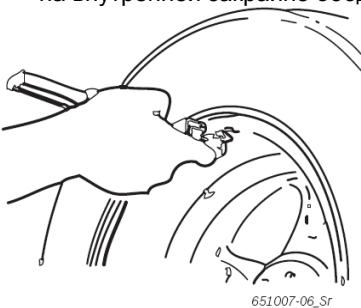
2. Приведите щипцы для наружных грузиков в соответствующее положение, в котором должны закрепляться балансировочные грузики.
