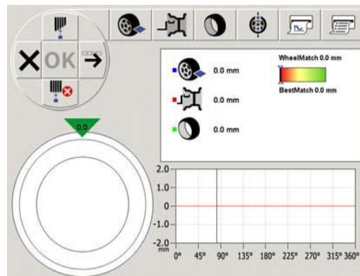
3. Запустите процесс измерения колеса в сборе нажатием клавиш «→» и OK.
