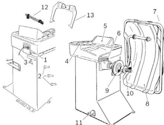
Рис. 1. Станок для балансировки колес (см. расшифровку позиций в нижеследующей таблице).
