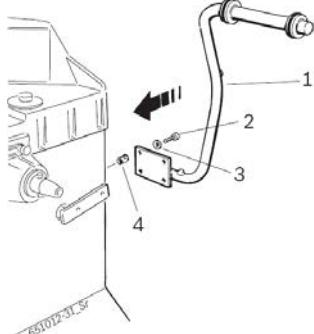
**Рис. 2. Закрепление опорного рычага на станке для балансировки колес WBE 4105:**
