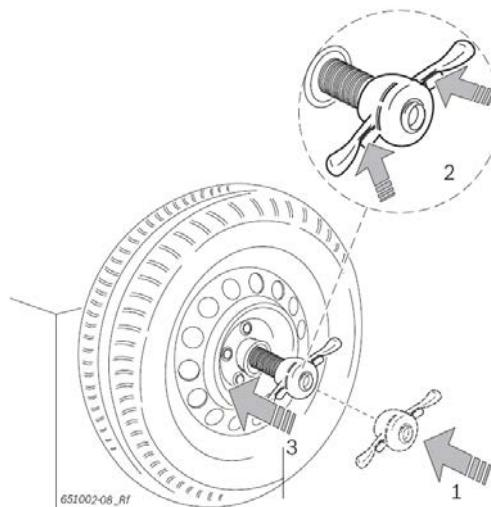
5. Ослабьте деблокирование и поворачивайте быстроажимную гайку по часовой стрелке до тех пор, пока колесо не будет прочно зажато.
