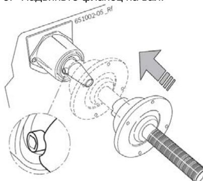
4. Затяните до отказа винт с шестигранным отверстием в головке.
