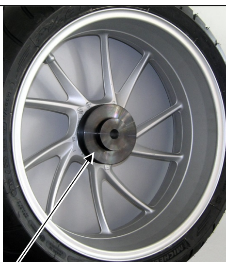
Установка соответствующего центрирующего диска
