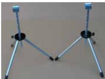
Вставить регулировочный шток в крепежный конус и зафиксировать его.
