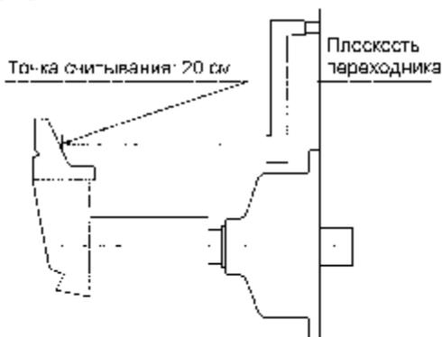
Проверьте, чтобы линейка, используемая для замера РАССТОЯНИЯ до колёс показывала бы 20 см в качестве величины расстояния от плоскости фланца. Если градуированная шкала заменяется, то установите её на отметку 20 см в качестве места фиксирования (точки считывания) в положении когда измеритель совмещён с плоскостью переходника.
