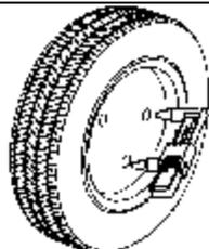
2) Измерьте расстояние между двумя отверстиями колеса поставленным в комплекте измерителем.
